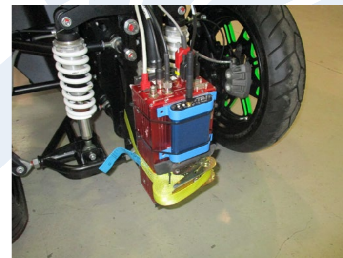
Jednotka CARSCOUT umístěná na prototypu vozítka v rámci Evropského projektu RESOLVE
