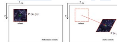
Obr. 3: Sledovaný bod na povrchu vzorku s náhodnou texturou
