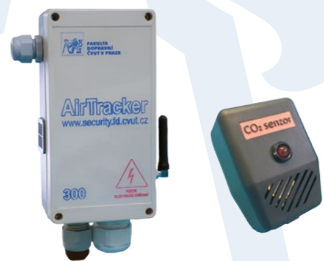
Senzorická jednotka AirTracker (vlevo) a jednotka pro měření CO2 ve vnitřním prostředí (vpravo)
