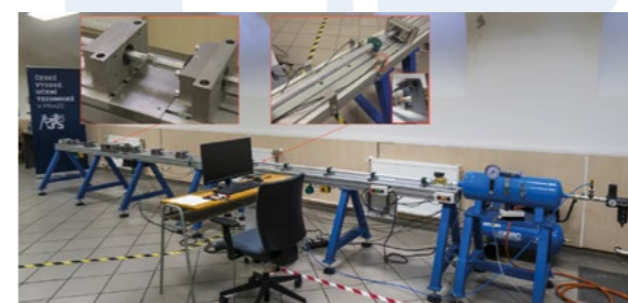
Obr. 1: Sestava SHPB na Ústavu mechaniky a materiálů Fakulty dopravní ČVUT.
