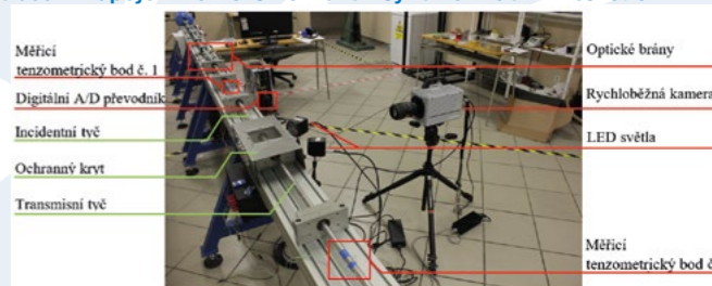
Obr. 7: Sestava pro měření rychloběžnou kamerou.
