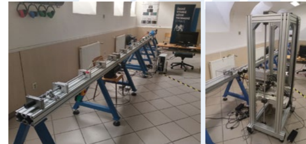
Obr. 1: Experimentální zařízení SHPB s tří-osým polohovacím systémem pro obrazový záznam dynamických dějů.
