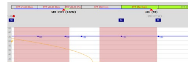
Obr. 8 Zobrazení brzdňových křivek jízdy vlaků pod dohledem systému ETCS v úrovni 3 (flexibilní řízení provozu s pohyblivým blokem)
