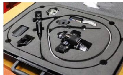
Obrázek 7 Fibroskop využívaný při nepřímé vibrační kontrole
