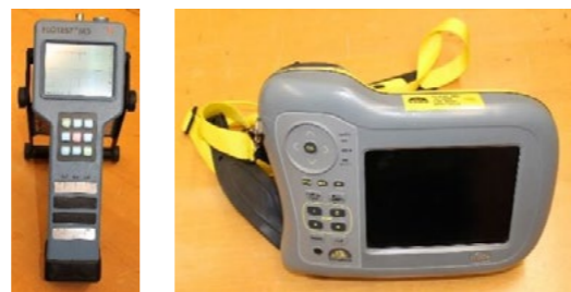
Obrázek 6 Přístroje využívané při metodě vířivých proudů (A) a při ultrazukové metodě (B)
