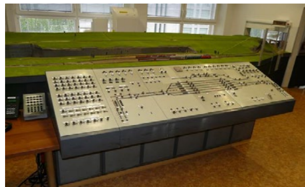
Obr. 4 Reléové zabezpečovací zařízení
